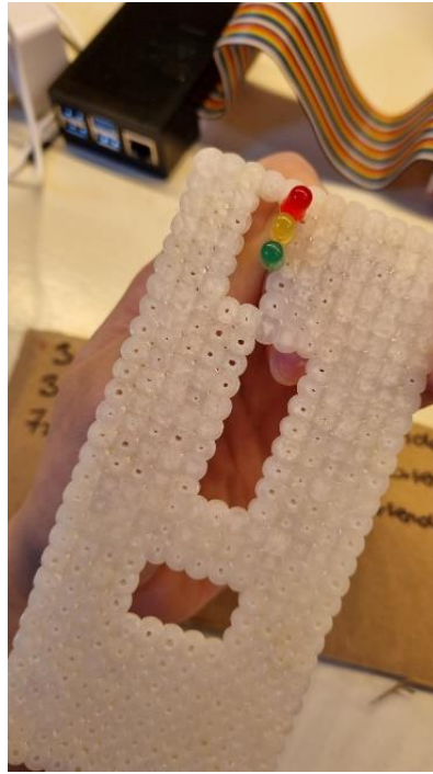
Figuur 16: Een vervolg op de kartonnen behuizing gemaakt van strijkkralen. Dit moet de bovenkant van de behuizing worden. Er zijn gaatjes voor de ledjes, de knoppen en de 7-segment display. Op basis van dit prototype heb ik de gaatjes voor de led lampjes in de definitieve behuizing kleiner gemaakt en die voor de knoppen juist groter. (Emma)
